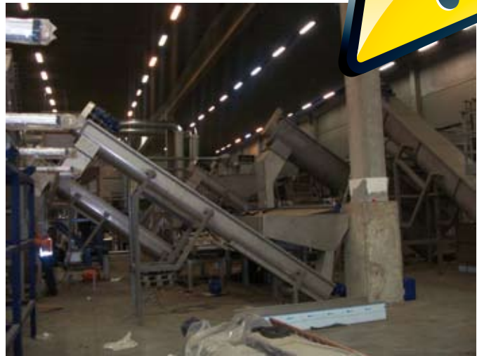
Ook een schroeftransporteur kan soms als een stand-alone machine functioneren (Foto ESV).
